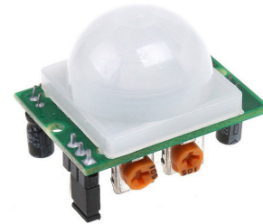
Figura 5. Sensor de movimiento PIR-SR501
